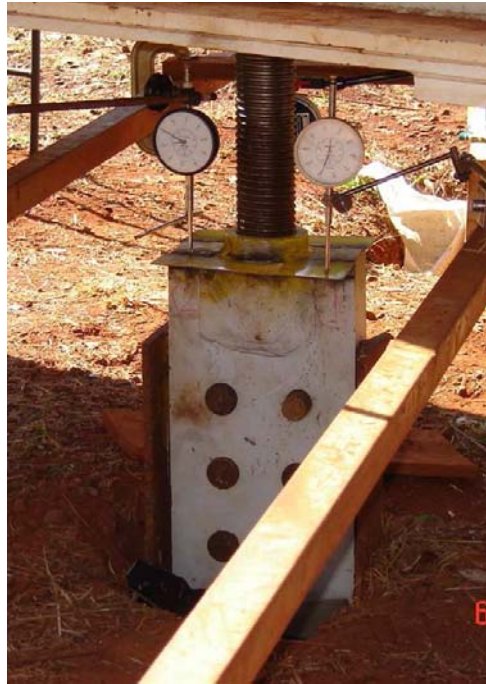
Figura 2.42. Relógios apoiados sobre as chapas da garra.
