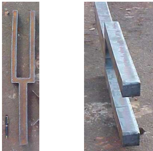
Figura 2.30. Vistas do “garfo metálico” utilizado na suspensão dos segmentos de tirante no interior da escavação.
