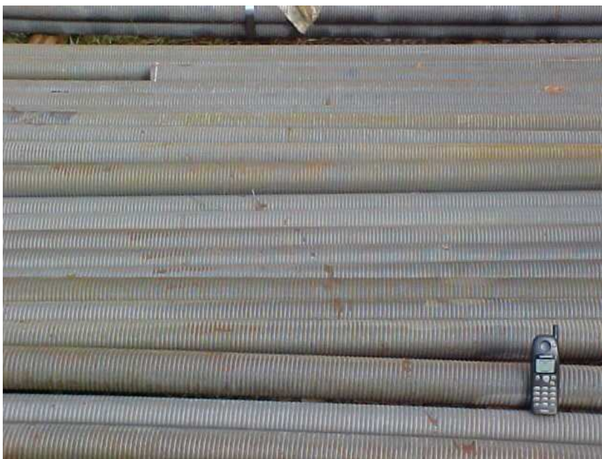
Figura 2.22. Tirantes utilizados no interior das estacas teste.
