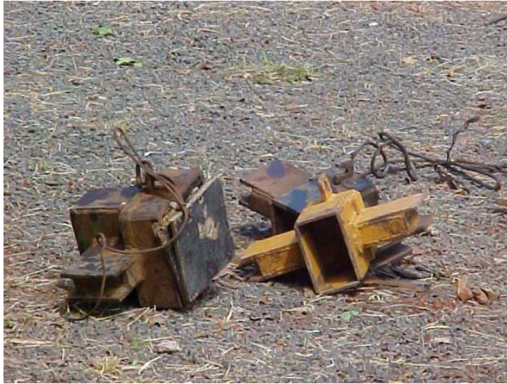
Figura 2.35. Capacetes utilizados na cravação das estacas.
