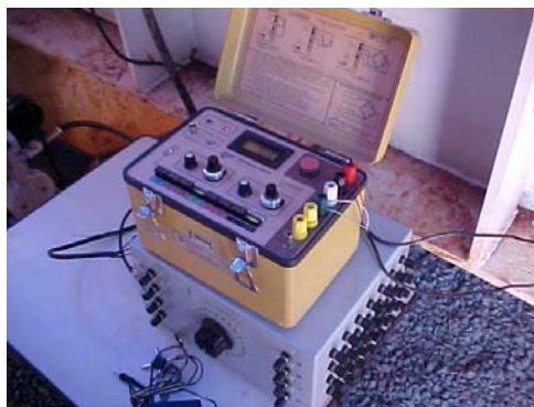
Figura 3.5. Caixa seletora de canais conectada à caixa de aquisição de dados.
