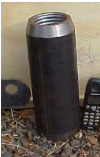
Figura 2.25. Luva de solidarização de segmentos de tirante.
