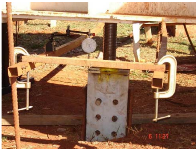
Figura 3.12. Relógio comparador com haste apoiada na garra de tração.
